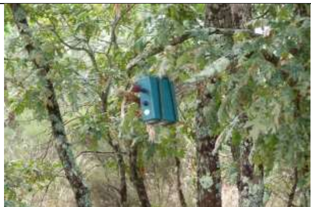
Figure 9 : Enregistreur à ultra-sons implanté dans un arbre
